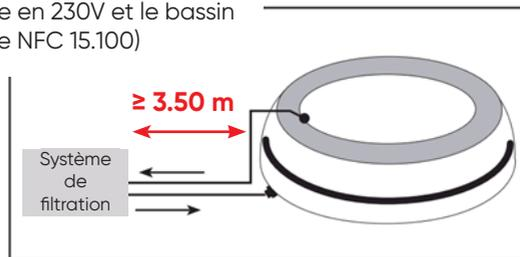
Il est obligatoire d'utiliser une prise de courant équipée d'un disjoncteur différentiel de 30mA. **Plus de détails page 18 et 19 de cette notice.**
