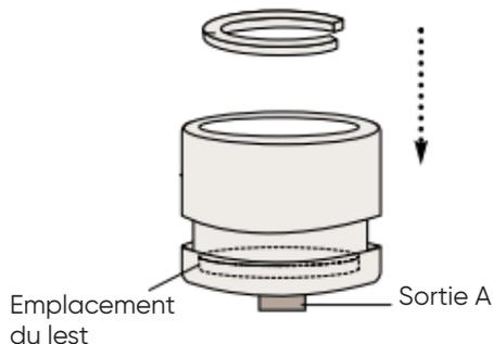
4. Vérifiez que le corps est bien enclenché dans l'ensemble du flotteur, mettez le panier de pré-filtre dans le corps, puis placez le flotteur sur le corps.
