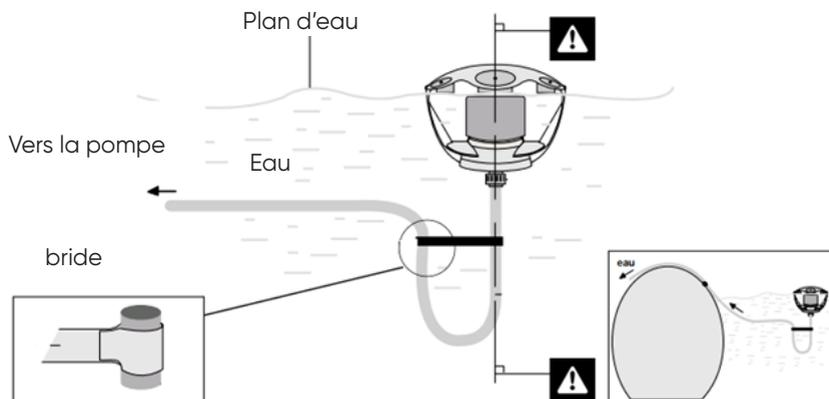
Étant libre sur l'eau, ce skimmer flottant a l'avantage de se régler automatiquement par rapport au plan d'eau.
