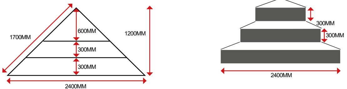
Ces escaliers peuvent être réalisés à l'aide d'escaliers d'angle sous liner, monoblocs (se renseigner auprès de votre revendeur) ou de blocs Solidbric et de nez de marche type «U». Pour réaliser une marche de 30cm de profondeur, il faut simplement décaler les rangées de blocs entre elles de 5 cm, et les caler les unes vis-à-vis des autres et de les remplir de béton les blocs. Ci-dessous le nombre de blocs droits pour une base de 3m ou de 2,40m.
