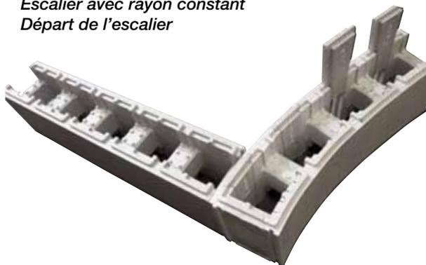
Pour le montage de l'escalier en blocs cintrés sur la structure, la base des blocs cintrés doit rentrer vers la piscine si l'on veut obtenir un escalier, avec un rayon constant de 1,25 m et une largeur de 2,50 m.
